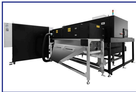
Il sistema di selezione della plastica "TR-S1510"
