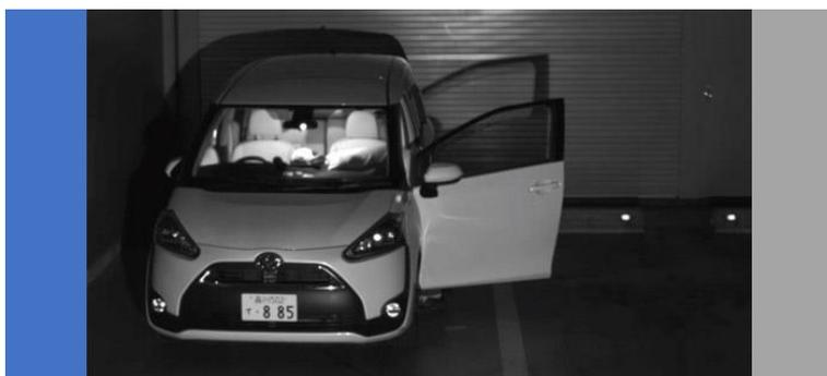
Esempio di acquisizione di immagini NIR (vicino infrarosso) in un parcheggio sotterraneo buio
