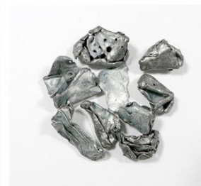
Acciaio ricavato dagli MFD raccolti da Canon Ecology Industry (a sinistra: acciaio misto a rame; a destra: acciaio raffinato al 99% di purezza)
