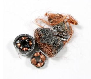
Acciaio ricavato dagli MFD raccolti da Canon Ecology Industry (a sinistra: acciaio misto a rame; a destra: acciaio raffinato al 99% di purezza)
